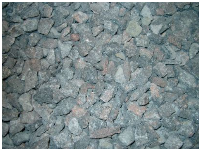
Figur 5.7 Närbild på 8-16-material
