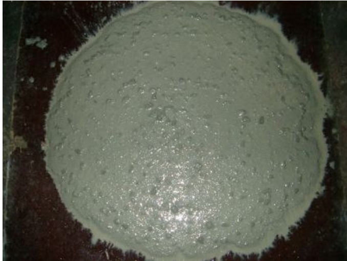
Figur 5.4 Provning av flytsättmätt
